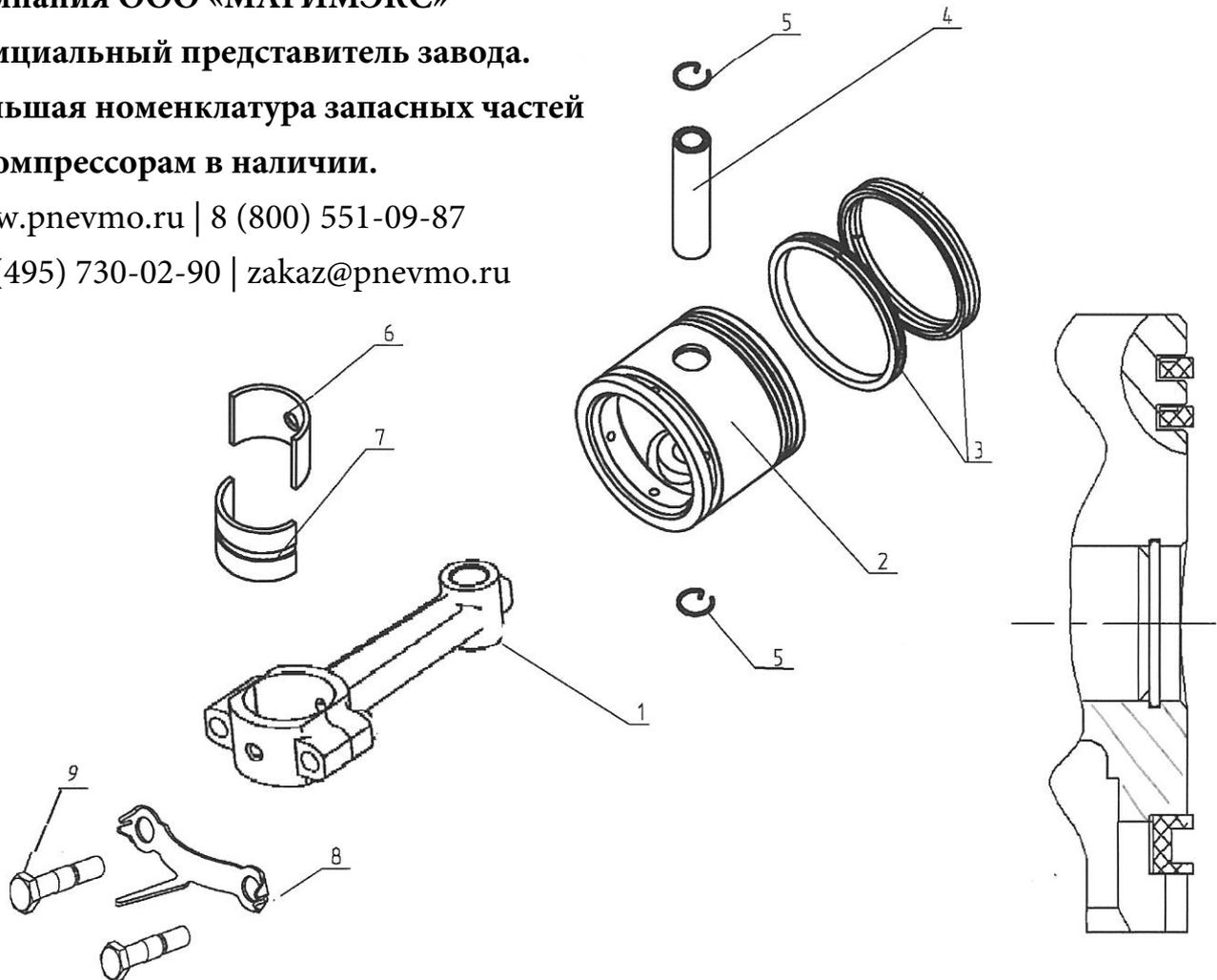
**Спецификация узла С412М.01.02.000**
